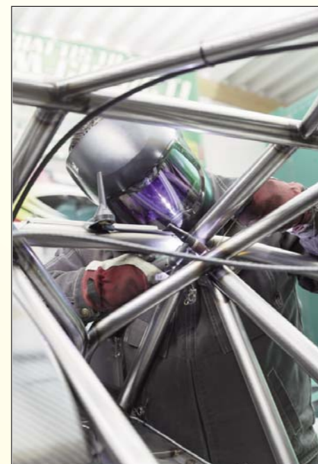
A 3M Speedglas G5-02 hegesztőpajzs 2,5-es fényfokozatú világos állapottal és széles kazetta látóterrel rendelkezik.
