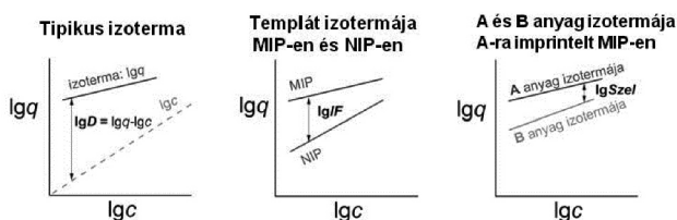
4. Ábra. A megoszlási hányados ( D ), az imprinting faktor ( IF ) és a szelektivitás ( Szel ) leolvasása a lgq - lgc ábráról
