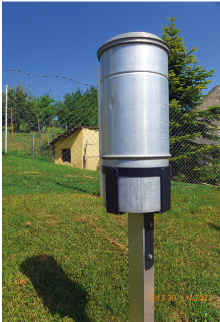
1. ábra. Oláh-Csomor-féle kettősfalú ombrométer a mernyei állomás belső udvarában.
