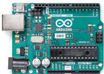
1. ábra: Arduino uno mikrokontroller. Forrás: Net1
