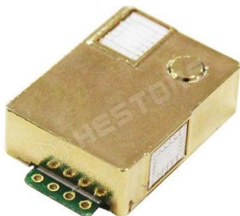
3. ábra: MHZ19B levegő CO 2 -szint érzékelő modul. Forrás: Net3
