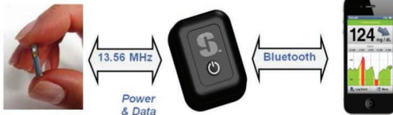
Senseonic CGM System – Szenzor (méret: 3x16 mm), Transzmitter (méret: 40x40x14 mm) és okostelefon applikáció
