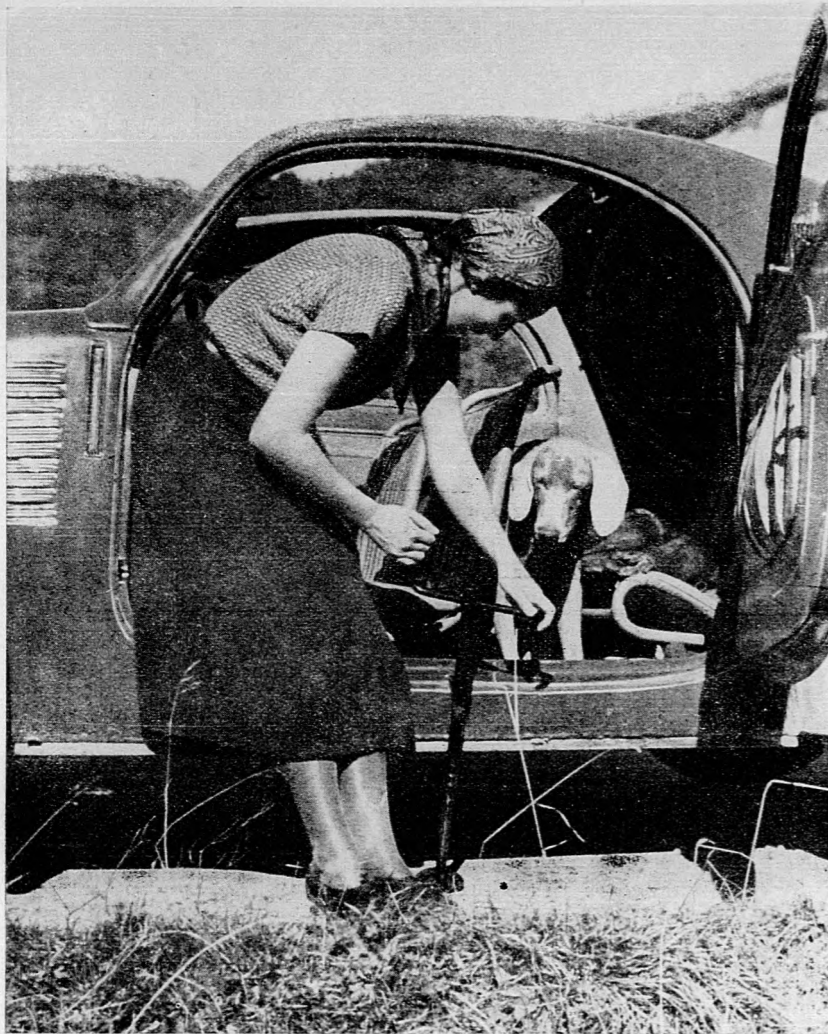
Kerékesere? A Steyr 50-be beépített Vigot kocsimeleivel gyerekjáték a kocsii felemelése.
