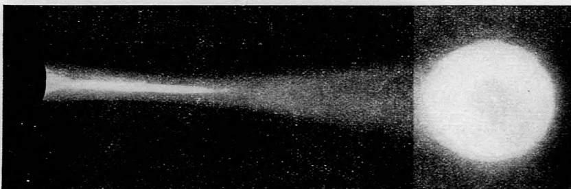
2. ábra. Ilyen lesz a fénykéve, ha a kisméretű izzóhoz konstruált fényszóróba nagyméretű izzót helyezünk.
