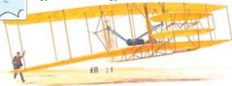
Az első motoros repülőgép 1903-ban szállt fel. Az amerikai Wilburs fivérek építették fából, szövettel bevont dupla szárnyal. A pilóta az alsó szárnyon fekve irányította a gépet.
