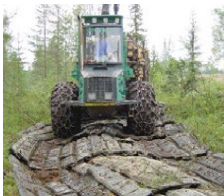
6. ábra. Útpálya vastag gumiszőnyegekből (Lassila, K., 2002)
