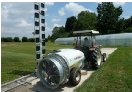
13. kép: Tértbéli eloszlás mérése függőleges mérőpaddal
