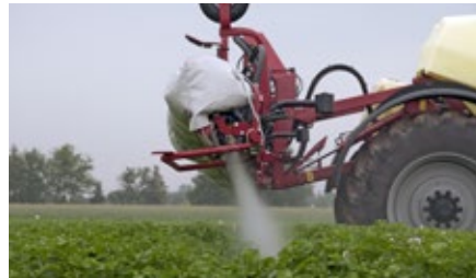
8. kép: Léfgüggönyös permetezés
