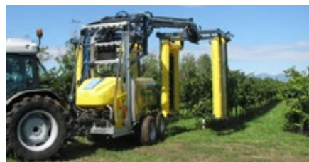
9. kép: Permetlé felfogó és visszaforgató rendszer
