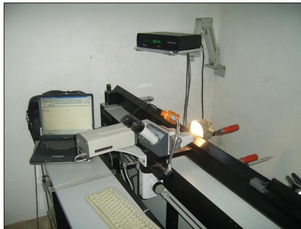
1. ábra. DIGITALPOSITIONIMETER Type 2 típusú évgy r analizátor berendezés az ERTI Püspökladányi Kísérleti Állomásán.
