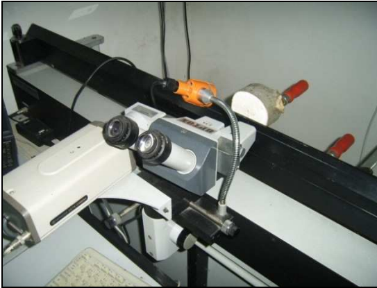
1. ábra. DIGITALPOSITIONETER Type 2 évvűrű-analizátor berendezés
