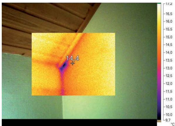
Építészeti felülvizsgálat: tömítetlen falsarok
