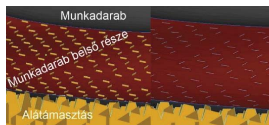
13. ábra: A támasz fogainak benövesztésének megszüntetése a munkadarabba
