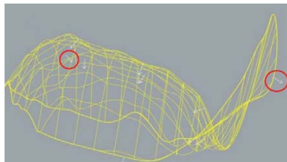
7. ábra: A vápa határait meghatároztuk, a felület normálisának irányjai a piros körökkel vannak jelölve.
