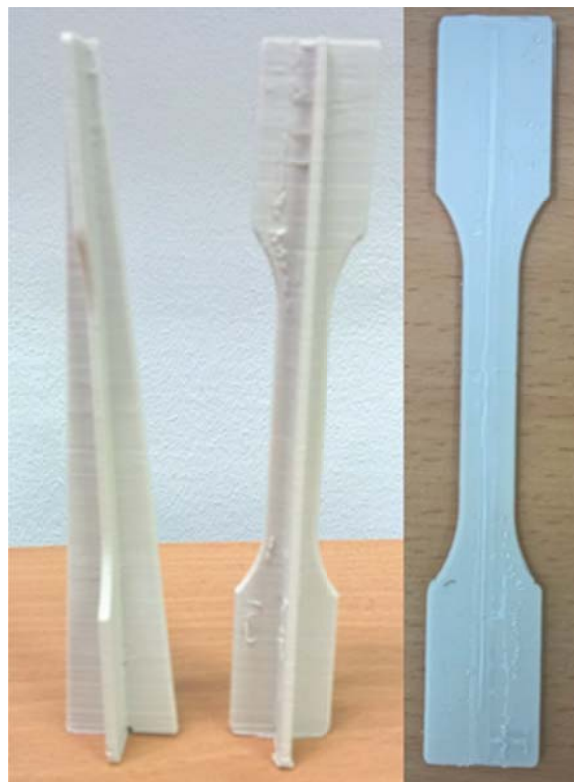
3. ábra Az állított (z-irányú) pozíciójú próbatest támasztékkal, majd a támaszték levágása után
