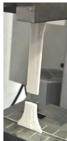
6. ábra Állított pozícióban nyomtatott próbatest, mely egyenesen, a réteg mentén elszakadt, jelentős kontrakció nélkül
