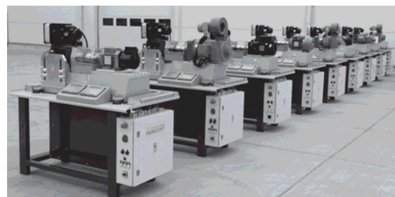
13. ábra. Az elkészült 10kW-os próbapadok.
