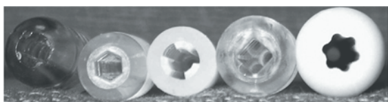
3. ábra Lebomló interferencia csavarok kulcsnyílásainak geometriái [5]
