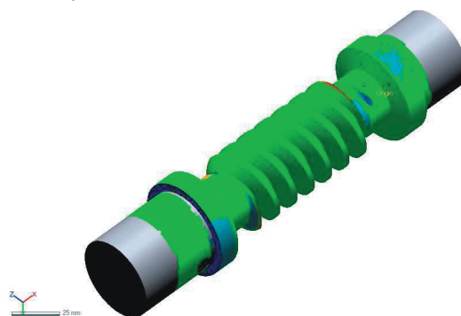
7. ábra. Eltérés szemléltetése a végleges csigamodellen
