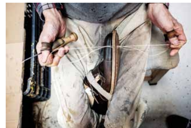
Cipőnél aljamunkának nevezik, amikor a talp rákerül a rámára. Először ragasztják, majd kézzel össze is varrják. A jelenleg kapható legjobb minőségű német bőrtalpakat használják. Korábban a sarkakat is helyben gyártották, de az elmúlt években beszállítóktól vásárolják, ez egyszerűsíti a gyártás folyamatát.
