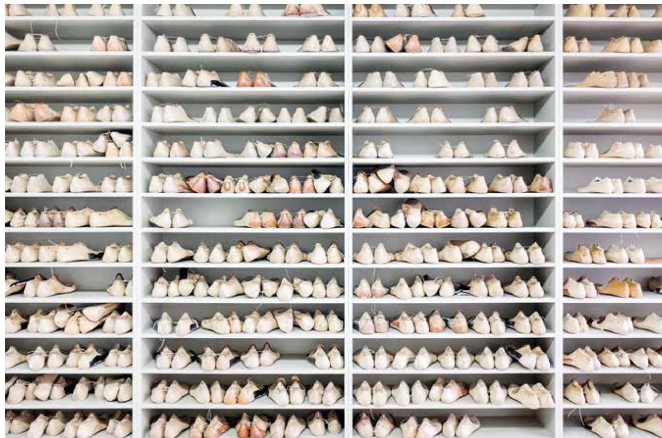
A kaptafa határozza meg a kész cipő alakját, ugyanis erre feszítik fel a bőrt. Vass László főleg a kaptafáinak köszönheti híret, mert konfekciómódelljei a legtöbb esetben első próbáláskor is kényelmesek. Zuglóí üzemiében őrzik az egyedi rendelésű kaptafákat is.
