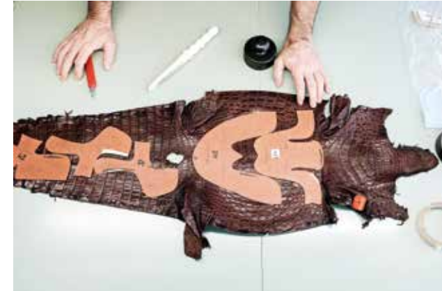
A cipőkészítés egyik első fázisa a szabás. A minták alapján kivágott részeket külső bedolgozók varrják össze, ez nem a Vass-műhelyben történik. A legdrágább egzotikus bőr a krokodil, ebből is a bébikrokodil hasalja használható cipőkhöz, az idősebb példányoknál ugyanis már ez is szarusodik, ami nem hajlékony és a legjobb szike sem vágja át. Egy pár cipőhöz két krokodil kell, így érthető, miért kerül a legolcsóbb modell is 600 ezer forintba.
