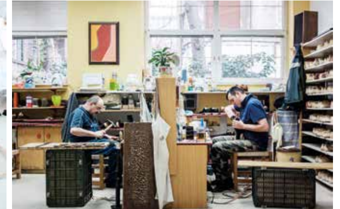
A megvarrt felsőrészek (kaptafára) kerülnek, ez a cvikkelás. Modellenként változó, de egy pár cipő felhúása átlagosan 1,5-2 órás művelet.
