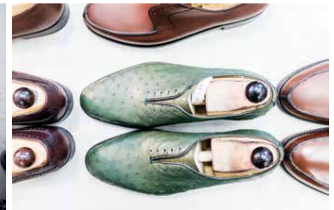
Az utolsó folyamat a kikészítés. A szerkezetkész cipő bőrt felületkezelik, puhítják, majd többféle technikával kézzel fényesítik, végül sámfázzák és dobozzák. A képen látható cipő egyedi rendelésre készült, struccbőrből.
