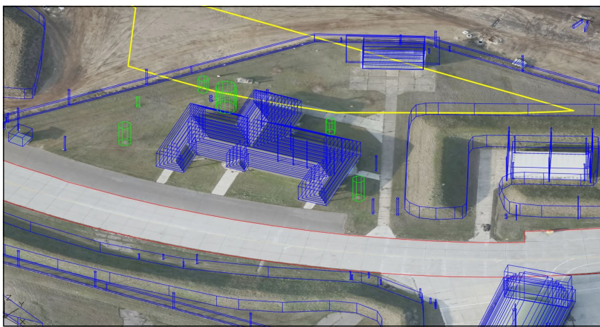
9. ábra. A Kecskemét Bázisrepülőtér Terület3 részadatbázisának megjelenítése AutoCAD-alapú térinformatikai rendszerben. (Kék: mesterséges (szegmentált) objektumok, zöld: természetes objektumok, sárga a Terület3 határvonal, piros a gurulótű szélé.)
