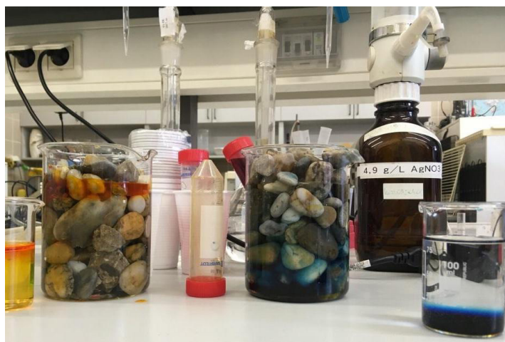
8. ábra. A különböző sűrűségű szennyezőanyagok (piros a víz tetején, kék az edény alján) elhelyezkedése a felszín alatti vizekben (fotó: Deák Anita)
