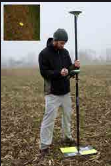
Terepi illesztőpont bemérése a geodéziai pontosságú légifotó-feldolgozás érdekében. A kis kép az illesztőpontot mutatja a drónfelvételen (fotó: Szabó Máté)
