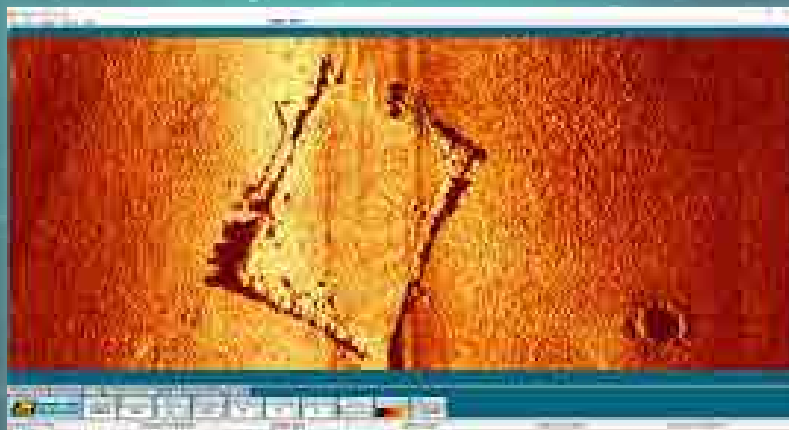
Oldalpásztázó szonár felvétele egy víz alatti objektumról
