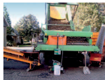
▲ Szállító szalagnál alkalmazott ULV fúvókás gép a GRO-STOP Basis kijuttatására.
