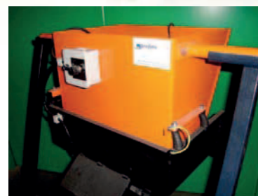
▲ A GRO-STOP 1% DP kijuttatására alkalmas porozó gép
