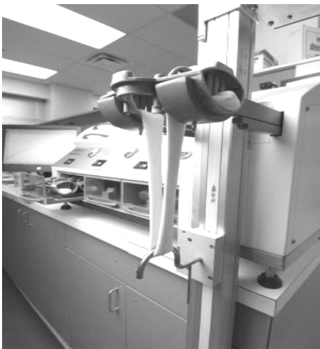
1. ábra: Brabender extenzográf tésztanyújtó szerkezete
