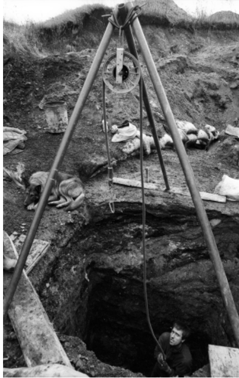
1. kép. Saját kezűleg készített csörlő, Walbrzych (Fotó: Paweł Pałgan)
