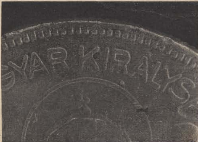
Öntött hamis 5 pengős, a KIRÁLYSÁG „R” betűje alatt öntési golyó. A pálcikás gyöngysor elmosódott.
