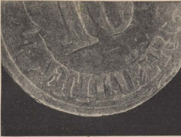
Veréssel készült 10 filléres. A „lapka“ elmozdulása miatt kettőzött körvonalak, különösen jól látszik a „fillér“ szónál.
