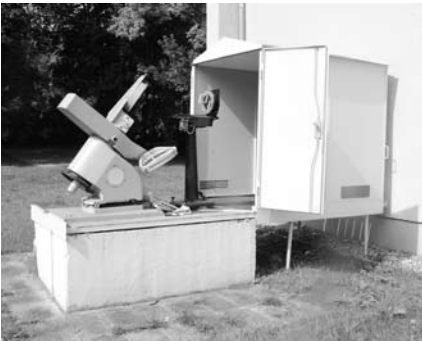
A napfényt az épület belsejébe vetítő cölöszttát. A napfényt a kb. a fal síkjában levő lencse gyűjti
