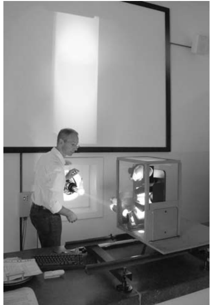
A Nap spektruma a vetítővászonon. Jól látható a falon át beérkező napfény útja, valamint a szinképet előállító prizmasor
