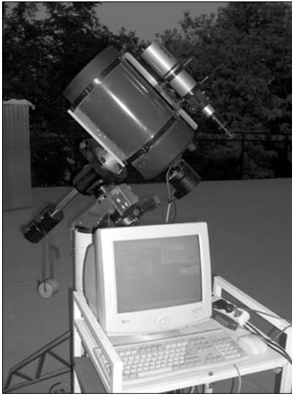
A Polaris Csillagvizsgáló 28 cm-es Schmidt-Cassegrain-távcsöve a teraszon, az ST-7E CCD-kamerával, melyet az AAVSO és a Curry Alapítvány támogatásának köszönhetően használhatunk
