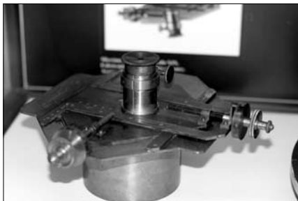
Remekművű okulármikrométer a Rio de Janeiro-i obszervatórium Heyde-refraktor kupolájában kiállítva
