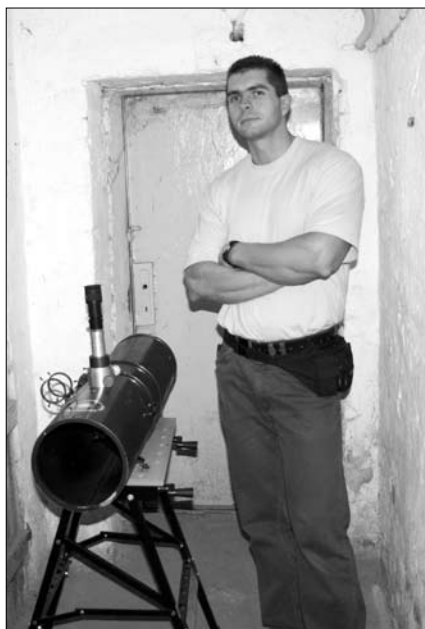
Helyi csoportunk egyike azon közösségeknek, amelyekben komoly távcsőépítő tevékenység folyik. Képünkön: műcsillagos tesztelés a próbapadon (Horváth Zsolt)
