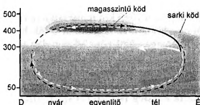
A Titan légkörének egyszerűsített meridionális szelvénye, a nyáriról a téli féltékére irányuló gázáramlással, és az elkülönülő, magasszintű szmogréteggel
