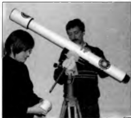
A tubus és az ellensúly felszerelése segítséggel (balra) és segítség nélkül (jobbra). A felszerelést mindig kioldott tengelyekkel végezzük
