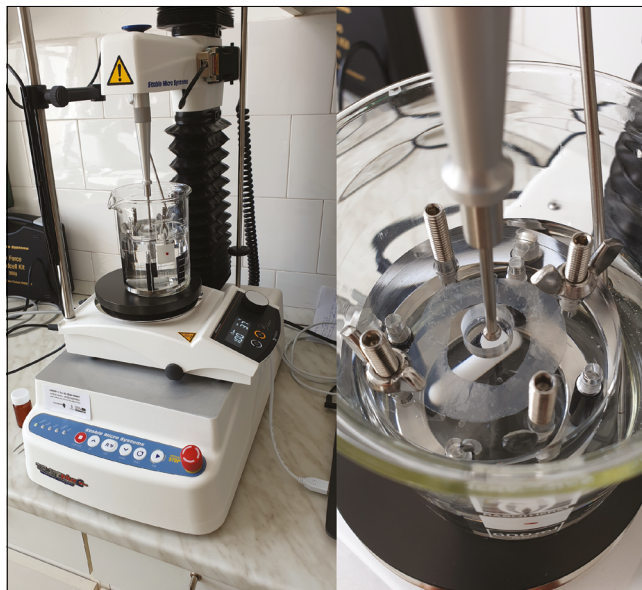
1. kép: A rendszerek keménységének vizsgálatára használt berendezés
