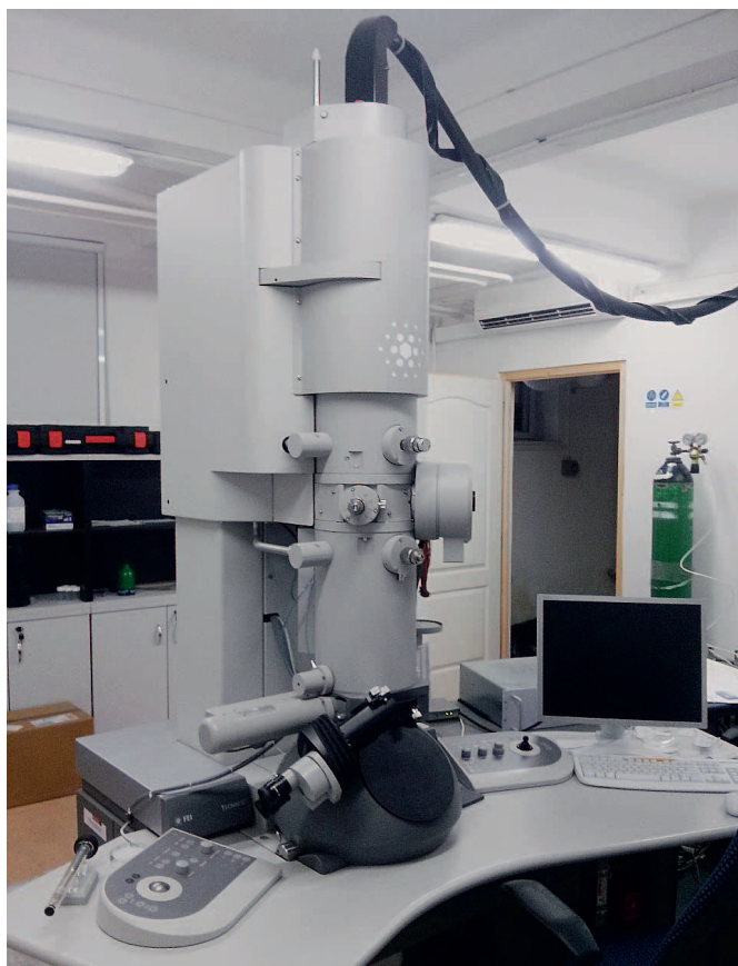
2. ábra. Az Intézet nagy felbontású transzmissziós elektronmikroszkópja
