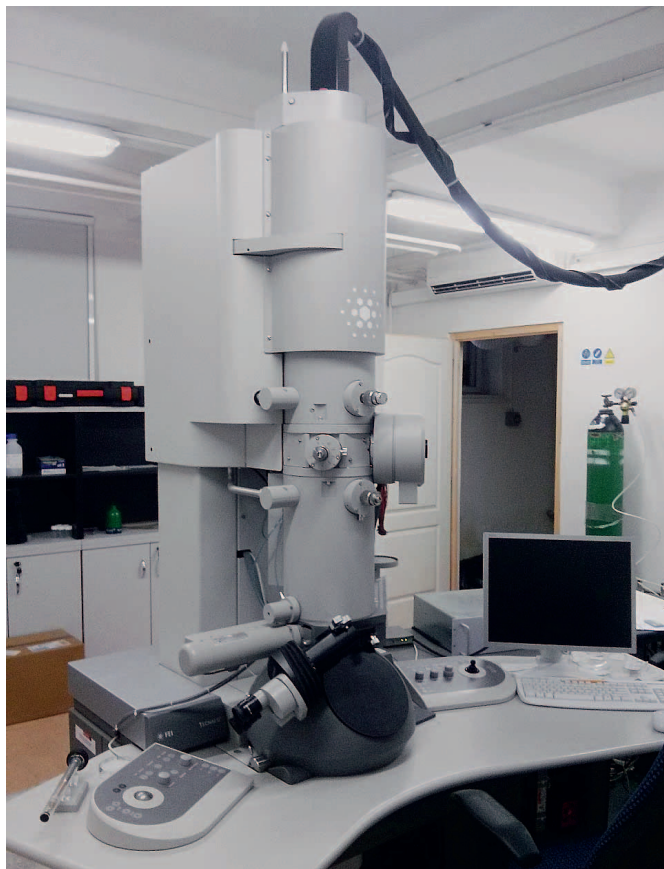
2. ábra. Az Intézet nagy felbontású transzmissziós elektronmikroszkópja
