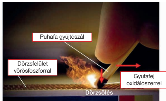
A dörzsölés hatására a gőzzé alakult vörösfoszfor gyűjtja be az oxidálószerrel a gyufafejben → az égés áttérjed a gyújtószálra
