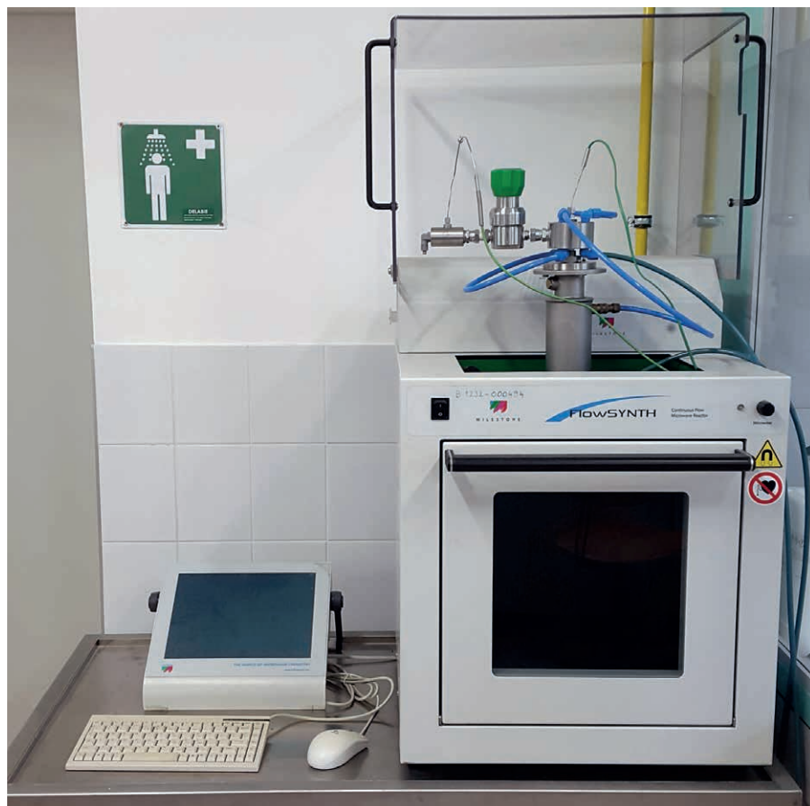
A csoport másik folytonos mikrohullámú reaktora. Fölül a hűtő látszik. Alatta teflonszöben játszódik le a reakció. „Ezt magunk alakítottuk át a megfelelő kapacitásra”
