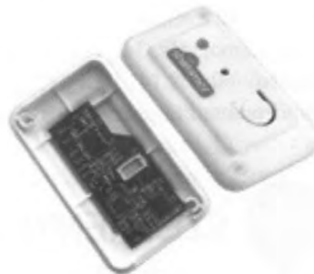
11. ábra. Giroszkópos szenzor Forrás: Wireless Gyro Sensor
