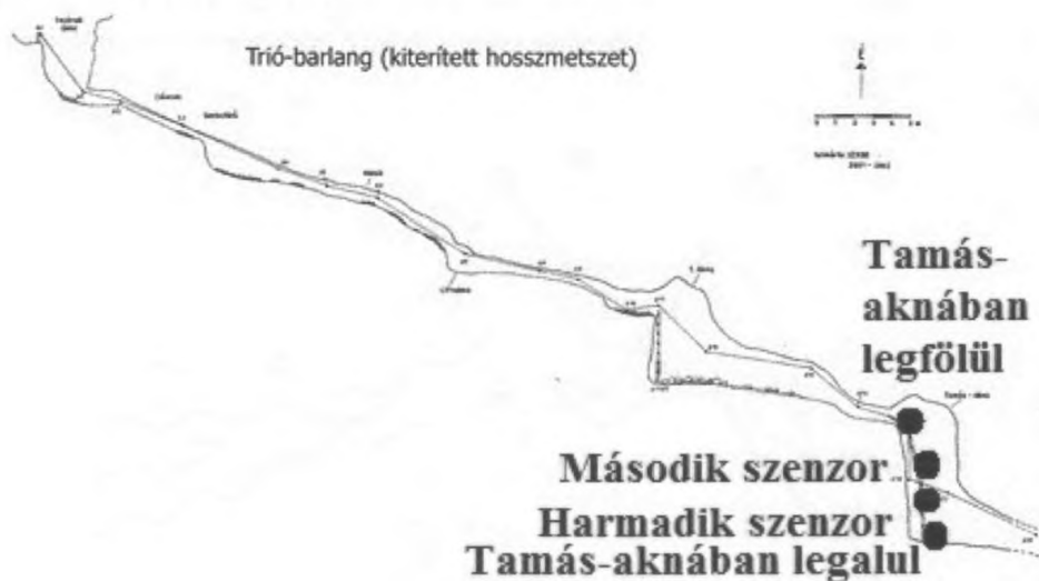
8. ábra. Tamás-aknában a szenzorok helye Barlangtérkép forrása: SZKBE 2001–2002, alapján saját szerkesztés
