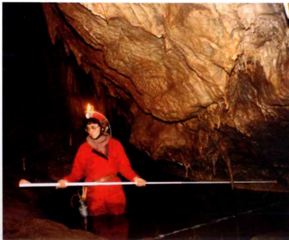
Részletpontok bemérése tetszkópos mérőrúddal. ↓
