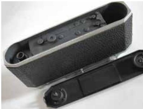
A Canon IIB filmbetöltéskor, levett alsó lemezzel
