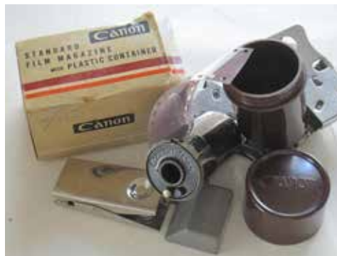
A csavarmentes Canon távmérős fényképezőgépek gyári filmkazettája
