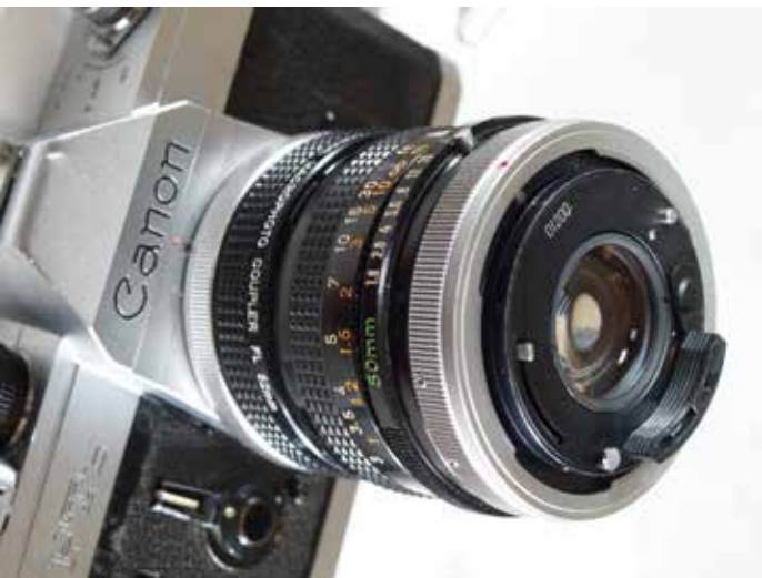
Canon FTb objektív-fordítós makró közgyűrűvel és többszatlakozós FD objektívvel © Fotó: Fejér Zoltán György, 2022.
