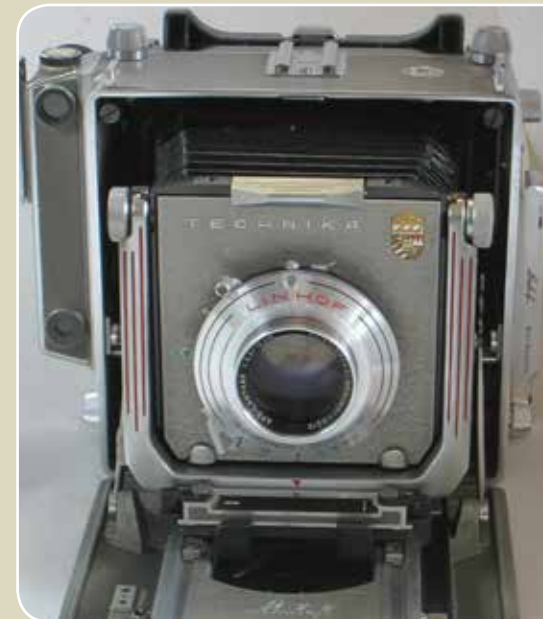
◀ Linhof Super Technika V-ös típusú fényképezőgép a Symmar normál objektívvel © Fotó Fejér Zoltán, Budapest, 2018 ▶ A 150 mm-es Symmarral 4x5 inches Foma síkfilmre készített próbafelvétel © Fotó Fejér Zoltán, Budapest, 2018
