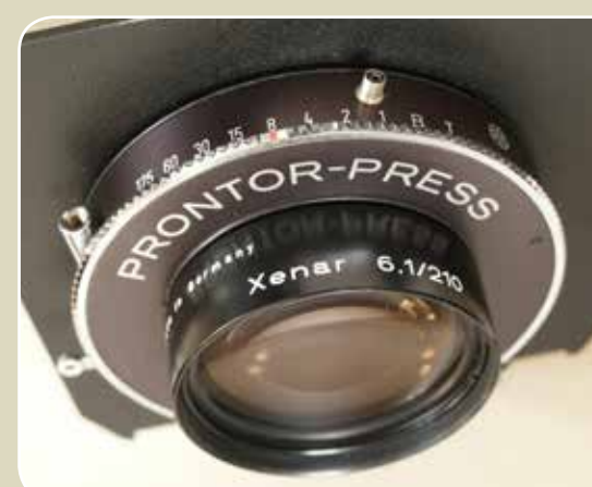
▶ A 6,1-es fényerejű Xenar objektív © Fotó Fejér Zoltán, Budapest, 2018 ▶ 4x5 inches síkfilmre a 210 mm-es Xenarral fényképezett próbafelvétel © Fotó Fejér Zoltán, Budapest, 2018
