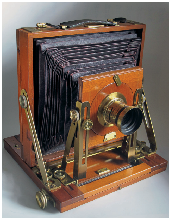
A Middlemiss kamera a szabadalom szerinti megoldással, nagylátószögű objektívhez történő kihuzat-beállítás
