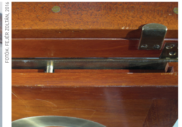
Az alaplapban lévő kis tengely és a hátlaptartó réz lap csatlakozása
