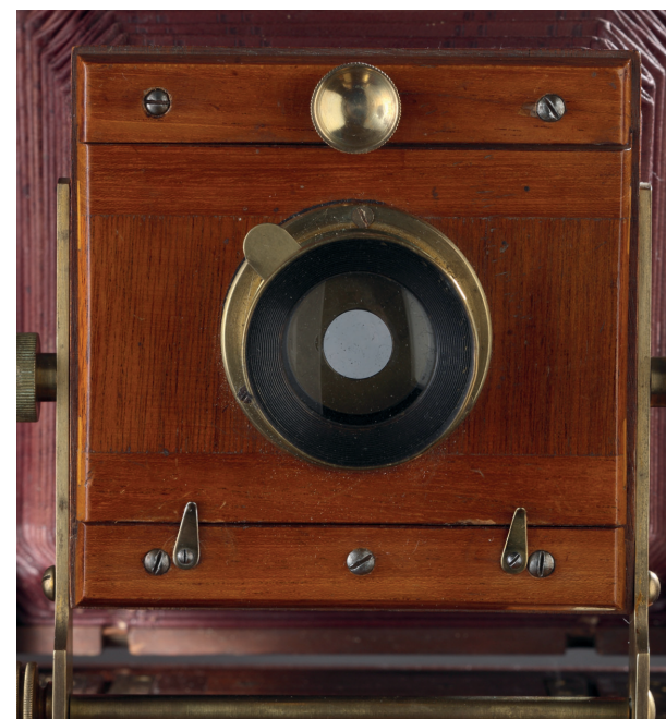
A Langer objektívtartó lapja a Goerz Rapid-Weitwinkel-Lynkeioskoppal
