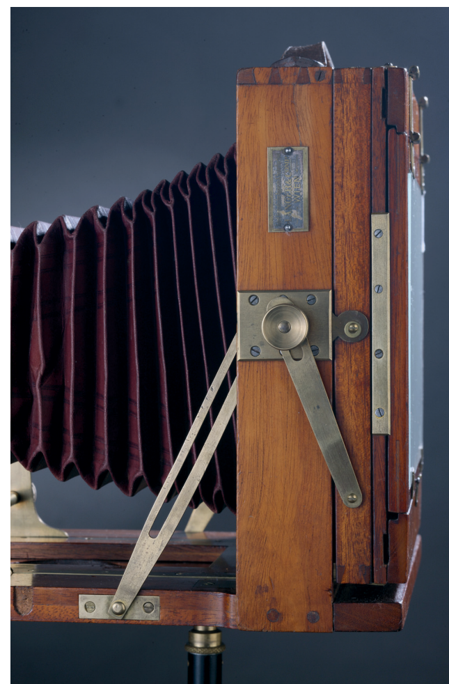
A Langer gépvázának oldalnézete a V alakban álló villákkal
