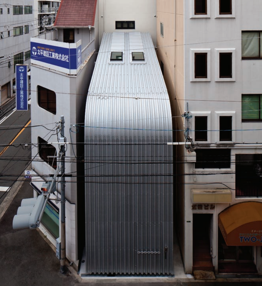
Roofecture OT2 , avagy városi rejtőzködő. Hullámlemez ugyan, de perforált, ezért egyenletes szűrt fényt kap a ház
