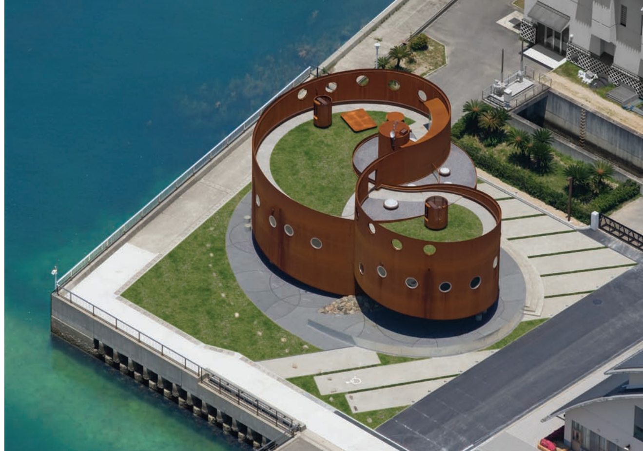
Bubblectecture H: környezetvédelmi központ és kiállítótér, japán cédrusból készült rácsos tartó, corten-acéllal fedve
