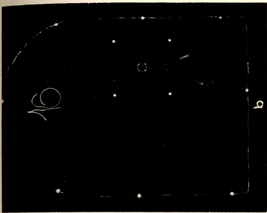
5. abra. Összehasonlítás körlelencsés vetítővel ( a ) és fotoprofilográfia ( b ) készített szelvénykép között. a. F. KOPPENWALLNER felv., b. a budapesti Mátyáshegyi-barlang betonburkolatú bejárati tárójának szelvénye. A pontmérőszög oldalhossza 500 mm. A szelvénykép hibaszámítás céljából készült. A kontúrvonalon látható fénypontok az egymáshoz képest bemért pontok helyét jelölik. (CSICSELY ANDRÁS felv.)
