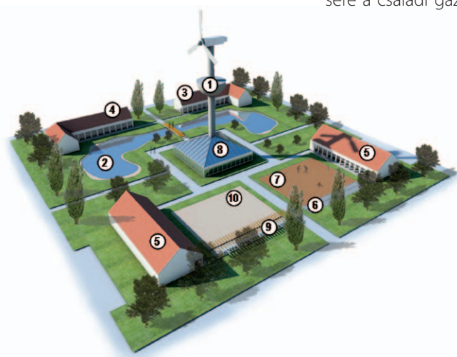
4. ábra • Tanyamag terve • 1 – szélkerék, víztorony, energiaközpont; 2 – halastó, kubikgödör; 3 – feldolgozó és árusítóraktár; 4 – raktár, hűtőház; 5 – közösségi épület; 6 – tekepálya; 7 – sportpálya; 8 – üvegház; 9 – lugas; 10 – játszótér.
