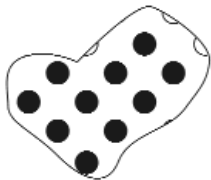
6. ábra. Felületi jelek kitöltési hibája MicroStation-környezetben. A kitöltésként használt körök színezése megszűnik a folt szélén, csak a teljes, a határoló vonalat nem érintő körök maradnak kiszínezve
